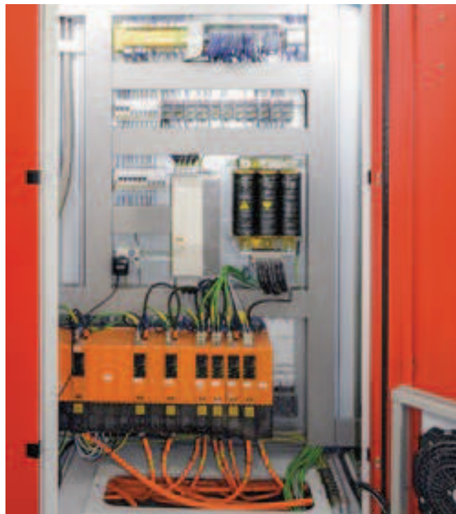
Ein Extruder erfordert ein besonders effizientes Energiemanagement um profitabel zu arbeiten. Mikrosan erreicht mit dem Einsatz des ACOPOSmulti einen aussergewöhnlich niedrigen Energieverbrauch mithilfe von Energierückgewinnung.
